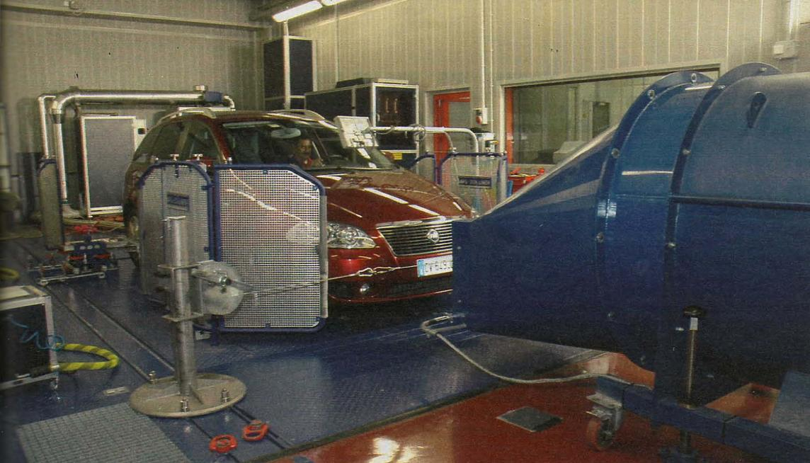
Per rilevare emissioni e consumi secondo l'omologazione, l'auto è fissata al suolo, mentre le ruote motrici fanno girare un rullo frenato da un motore elettrico, così da riprodurre la resistenza che si opporrebbe al movimento reale su strada
